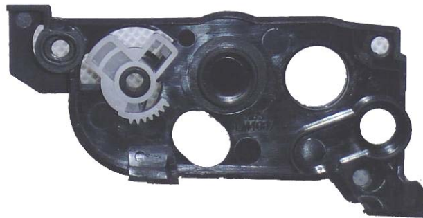
Fig. (TN-350) 9 - Engrenagem bandeira na posição correta.
