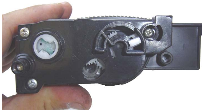
Fig. (TN-350) 4 - Lateral das engrenagens - note a janela em forma de meia-lua.
