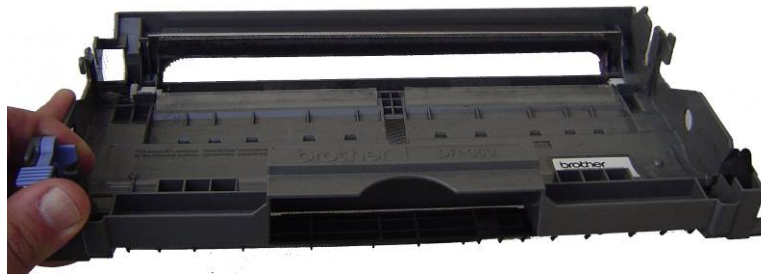
Fig. (TN-350) 17 - Sistema de fotocondução. Note que esta peça é parte integrante do sistema de alimentação de folhas.
