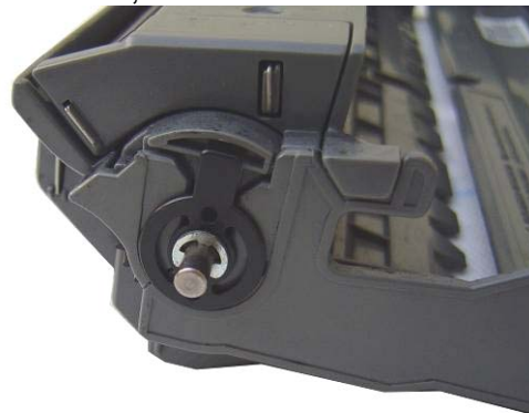
Fig. (TN-350) 12 - Arruela em "C" que trava o eixo do OPC.
